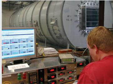
Túnel de viento y equipos de calibración
